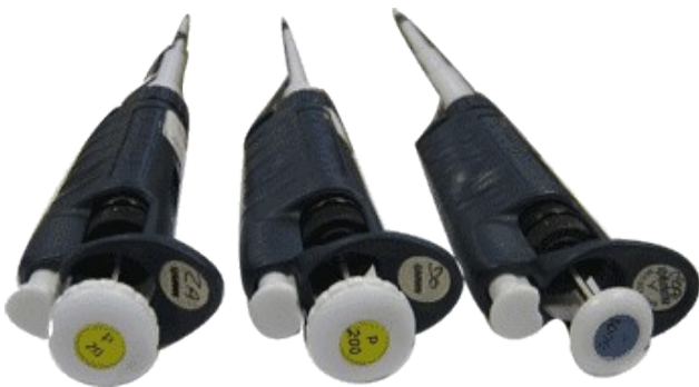
Micropipettors: P20, P200, P1000.
